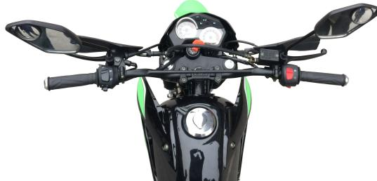
La palanca del embrague se usa para desacoplar el embrague antes de hacer los cambios. Hale la palanca hasta el final antes de hacer el cambio. Una vez hecho el cambio, suelte la palanca lentamente.
