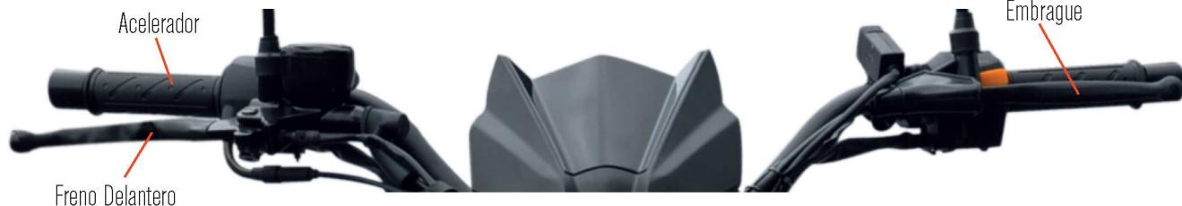
La palanca del embrague se usa para desacoplar el embrague antes de hacer los cambios. Hale la palanca hasta el final antes de hacer el cambio, una vez hecho el cambio suelte la palanca lentamente.
