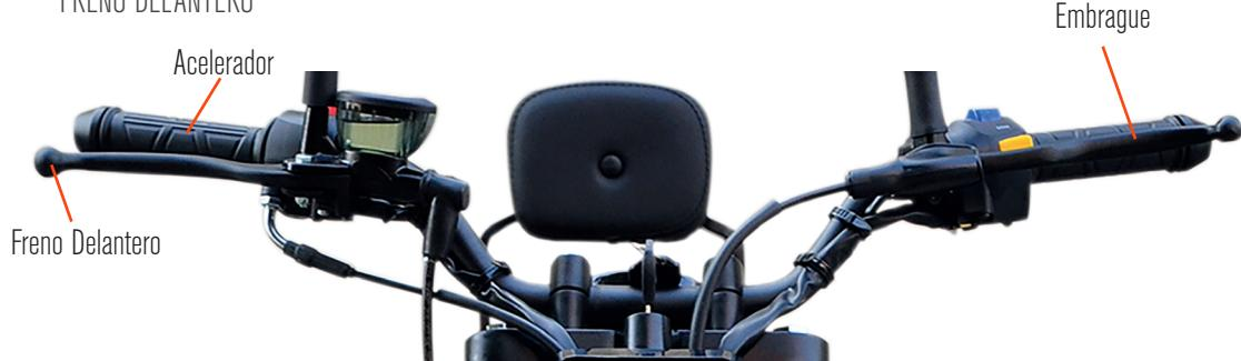
La palanca del embrague se usa para desacoplar el embrague antes de hacer los cambios. Hale la palanca hasta el final antes de hacer el cambio, una vez hecho el cambio suelte la palanca lentamente.
