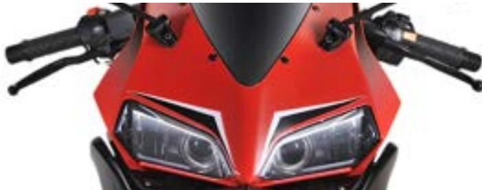
La palanca del embrague se usa para desacoplar el embrague antes de hacer los cambios. Hale la palanca hasta el final antes de hacer el cambio. Una vez hecho el cambio, suelte la palanca lentamente.
