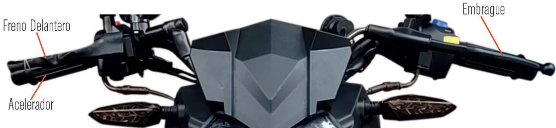
La palanca del embrague se usa para desacoplar el embrague antes de hacer los cambios. Hale la palanca hasta el final antes de hacer el cambio, una vez hecho el cambio suelte la palanca lentamente.
